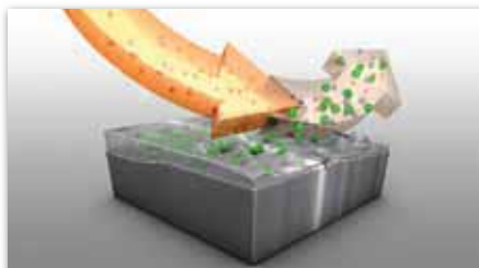
Grube ispune potkopane finim česticama
